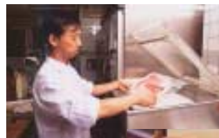
スイス製の真空ガスパック包装機で混合ガスを充填することで、食品の酸化(品質劣化)を防ぐことができる。
